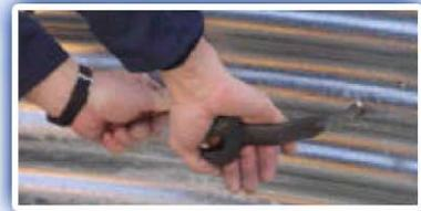
Vaso de 17 mm para los pernos del depósito.
